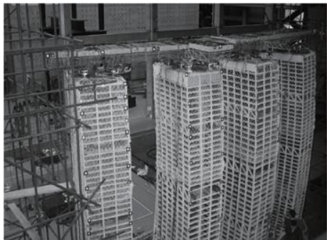
大型建筑物振动试验变形监测
