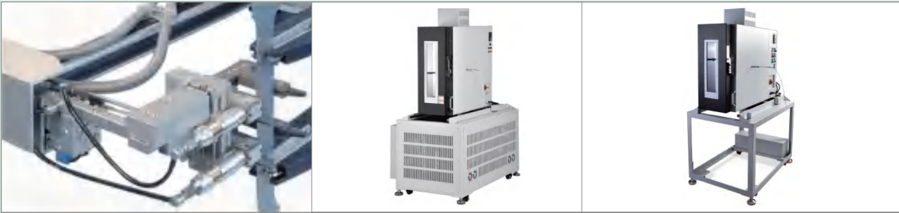
宽度规(选配) (广泛应用于r值以及泊松比的测量, 满足 ASTM E517以及ISO10113的要求)
